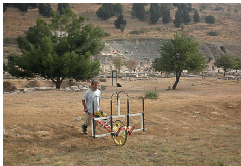
S. Seren (ZAMG) mit einem Föster FEREX Fluxgate 4-Sonden Magnetometer, Obere Agora 2012 (© ArcheoProspections@ ZAMG)
